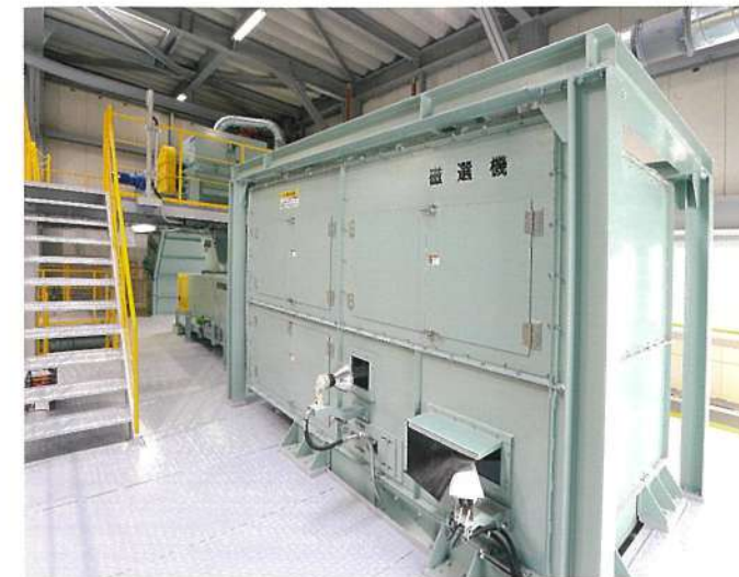
磁選機 電磁石を使って破砕物の中から鉄類を選別します。
